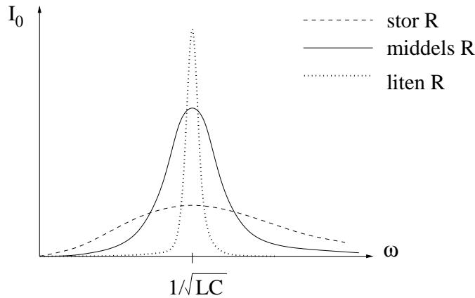
For riktig lave frekvenser ( $\omega \rightarrow 0$ ) representerer kondensatoren et brudd i en tilnærmet likestrømkrets. Da er det ikke urimelig at  $I_0 \rightarrow 0$ . For riktig høye frekvenser ( $\omega \rightarrow \infty$ , eventuelt  $\omega \gg \omega_0$ ) blir indusert motspenning i induktansen  $L$  stor selv uten strøm av betydning. Da er det heller ikke urimelig at  $I_0 \rightarrow 0$  i denne grensen.
