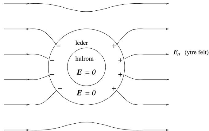
Dvs: Inne i hulrommet har vi elektrostatisk *skjerming* mot det ytre feltet.
