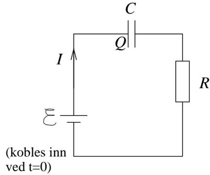
(Like-)Spenningskilden  $\mathcal{E}$  kobles inn ved tidspunktet  $t = 0$ . Da har vi null ladning på kondensatoren,  $Q(0) = 0$ .
