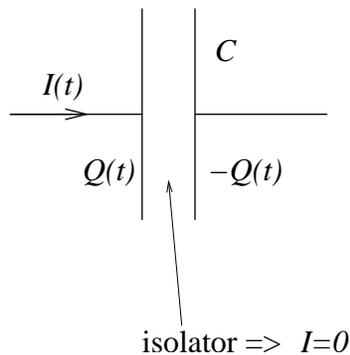
Vi kan imidlertid ha en *tidsavhengig* strøm  $I(t)$  inn og ut av kondensatorens ledere (*platene*, hvis det er snakk om en parallellplatekondensator).
