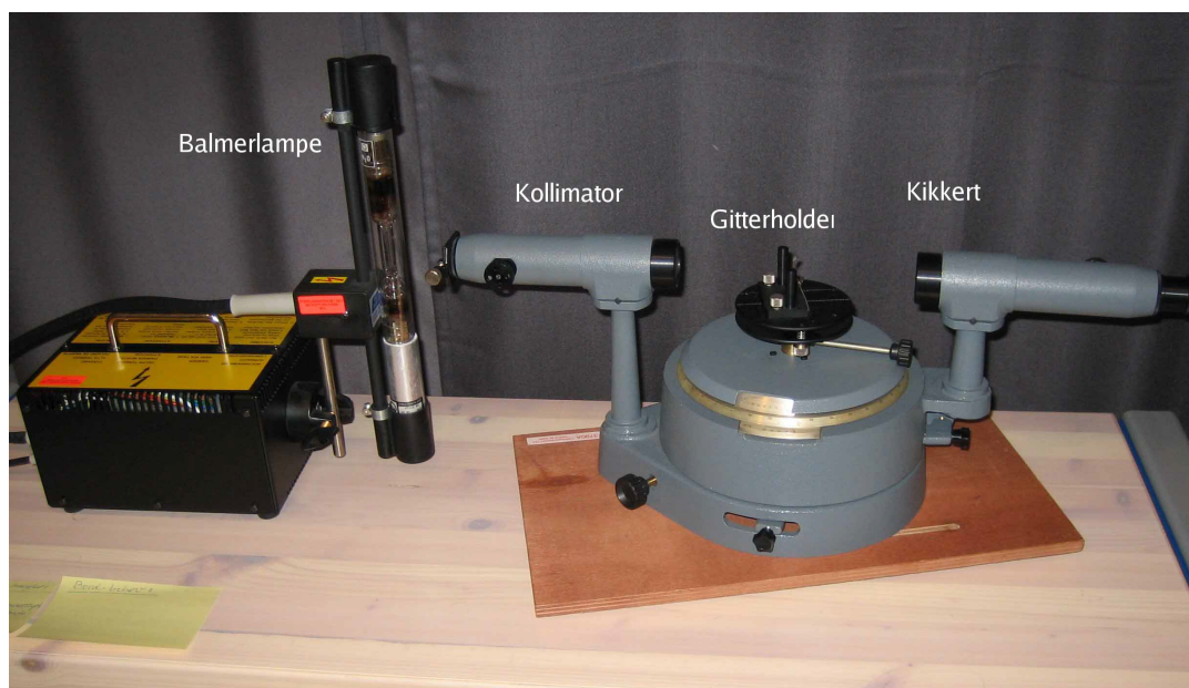
Figur 2.3: Fotografi av apparatoppsettet slik det er i laboratoriet.
