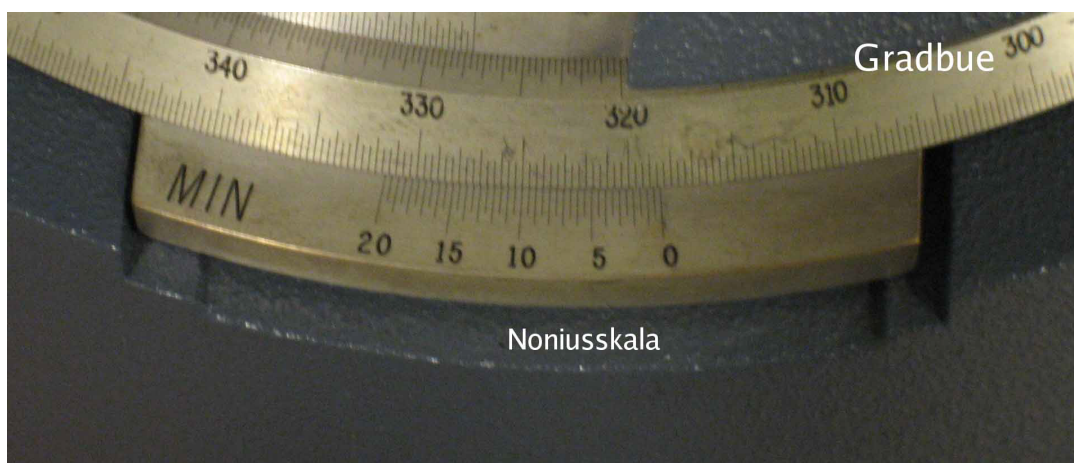
Figur 2.4: Avlesningen av avbøyningsvinkel gjøres på gradbuen. Tallene angir grader, og hver grad er delt opp i tre mindre avsatser som hver er på 20 bueminutter. En grad består altså av 60 bueminutter. I tillegg er det en noniuskala som angir avlesningen til en nøyaktighet på 30 buesekunder. Denne brukes på samme måte som noniuskalaen på et skyvelære
