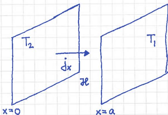
To store parallelle plan, innbyrdes avstand  $a$ , faste temp.  $T_2$  og  $T_1 < T_2$ .
