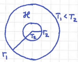
Konst. varme  $\dot{Q}$  pr tidsenhet gjennom kuleskall med areal  $A(r) = 4\pi r^2$
