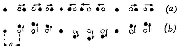
Longitudinale (a) og transversale (b) moder med bølgelengde 8a i en endimensjonal mono-atomær krystall. Pilene markerer atomenes utsving fra likevektsposisjonene.
