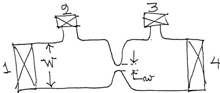
I den viste 4-punkts kontakten går strømmen fra kontakt 1 til 4, mens 2 og 3 er kontakter for spenningsmåling. Kontaktene regnes som ideelle. En geometrisk innsnevring med effektiv bredde  $w$  kan reguleres ved en portspenning  $V_g$  (arrangementet ikke vist i figuren). I den brede delen av systemet er  $W \gg l_B = \sqrt{\hbar/eB}$ , mens  $l_B > w$ .
