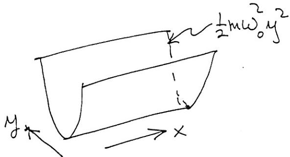
En ideell "ledning" i x-retning i den 2-dimensjonale elektrongassen er definert ved potensialet  $\frac{1}{2}m\omega_0^2 y^2$ . Elektronene i ledningen er utsatt for de elektromagnetiskefeltene
