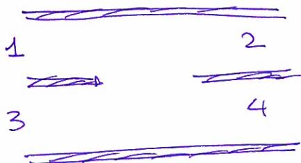
Størrelsen  $R_{L1} = R_{12,34}$  måles ved at en sender en strøm fra 1 til 2, mens en måler spenningen mellom 3 og 4.
