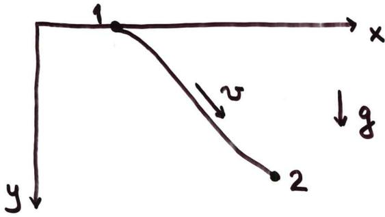
Finn den kurven mellom to punkter 1 og 2 som er slik at tilbakelagt tid for en partikkel blir minimal. (Anta null utgangshastighet.)
