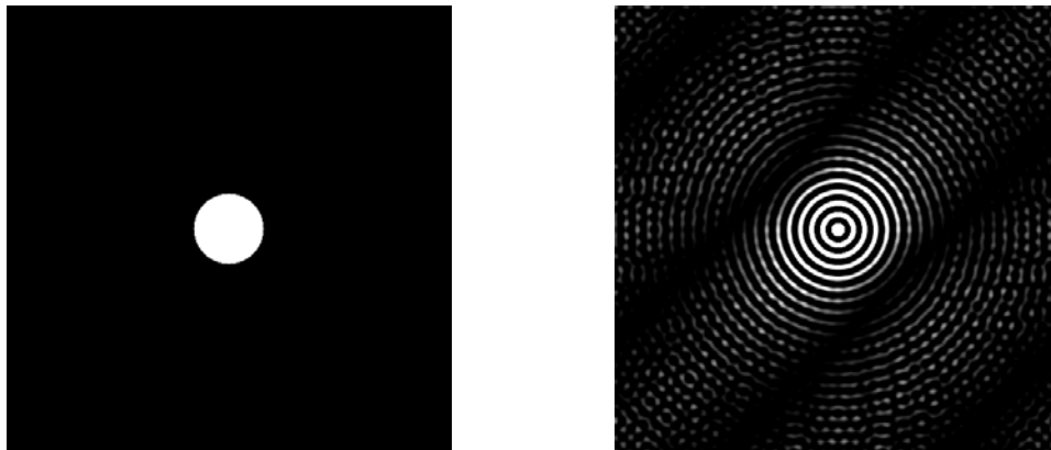
Figure 7: Lavpassfilterets transferfunksjon (venstre) og impulsresponsfunksjon (høyre). Programmet hadde en liten bug , slik at senteret for sirkelen i bølgetallsplanet er ett steg fra origo i hver retning. Derfor er ikke impulsresponsen helt sirkulær.
