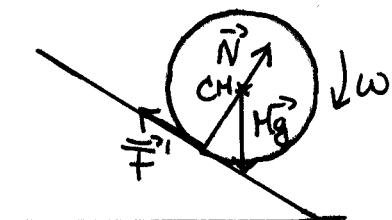
a)  $\vec{N}$  og  $Mg$  har ingen arm om massemiddelpunktet, CM,  $\Rightarrow$  ikke noe dreiemoment om CM og gir ikke nulling.
