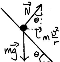
a) Partikkelen følger bevegelsen til skakta og roterer derfor med vinkelhastighet  $\omega$  i avstand  $r$  fra rotasjonsaksen. Partikkelen får sentripetalselerasjon fra  $N_{\text{horizontal}}$ :  $N \sin \theta = m \frac{v^2}{r} = m \omega^2 r$  (1)
